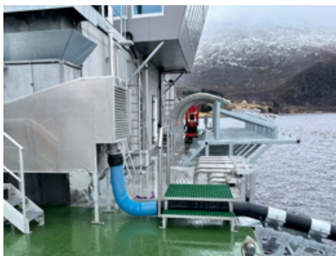
■ Botnfalli er dælt upp í prammann þar sem það er síað, pressað og geymt.
