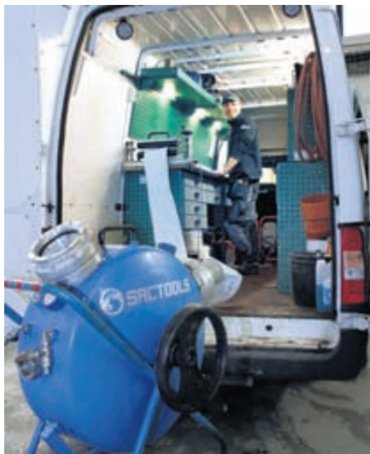
Tæknimaður Proline undirbýr sokkafóðringu.
