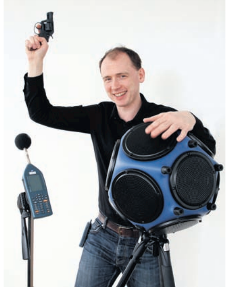
Halldór K. Júlíusson, hljóðverkfræðingur hjá Verkís, með hátalarakúlu, hljóðmæli fyrir mælingar og upptökur á hávaða og titringi og startbyssu fyrir mælingar á hljóðvist og enduróm rýma.
