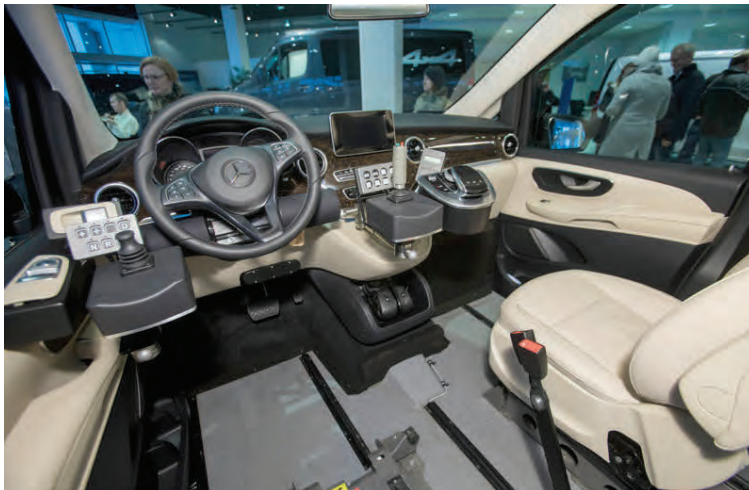
Búið er að setja tvo stýripinna sitt hvorum megin við stýrið en ökumennirnir nota stýripinnana til að stýra bílnum. Þar er m.a. að finna bensingjöf og bremsur.
