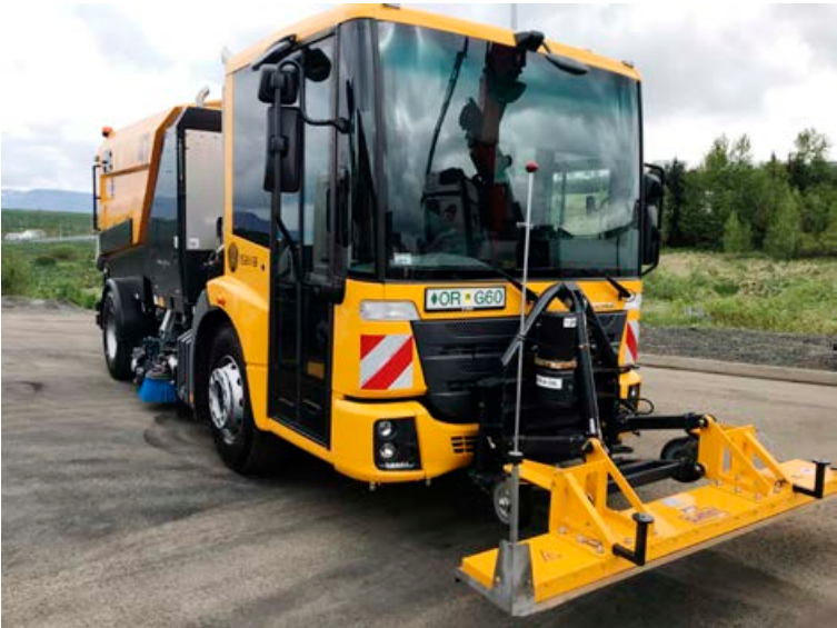
Aflvélar selja líka götusópa. Þessi er útbúinn með segulstáli að framan.
