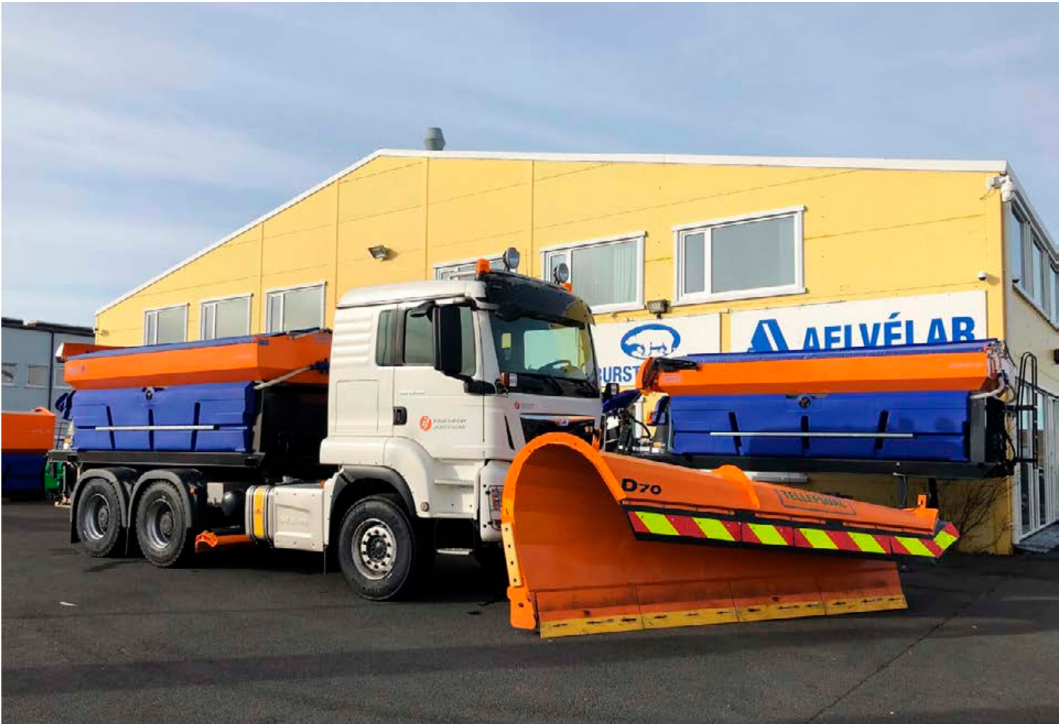
Hjá Aflvélum er hægt að fá allt sem þarf til snjóruðnings. Hér sést fullbúinn snjóruðningsbíl sem er með öllu tilheyrandi, bæði tönn og dreifara.
