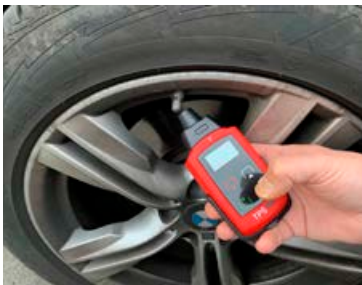
TEXA TPS er forritari fyrir dekkja-skynjara sem gefa upplýsingar um loftþrýsting og fleira í dekkjum.
