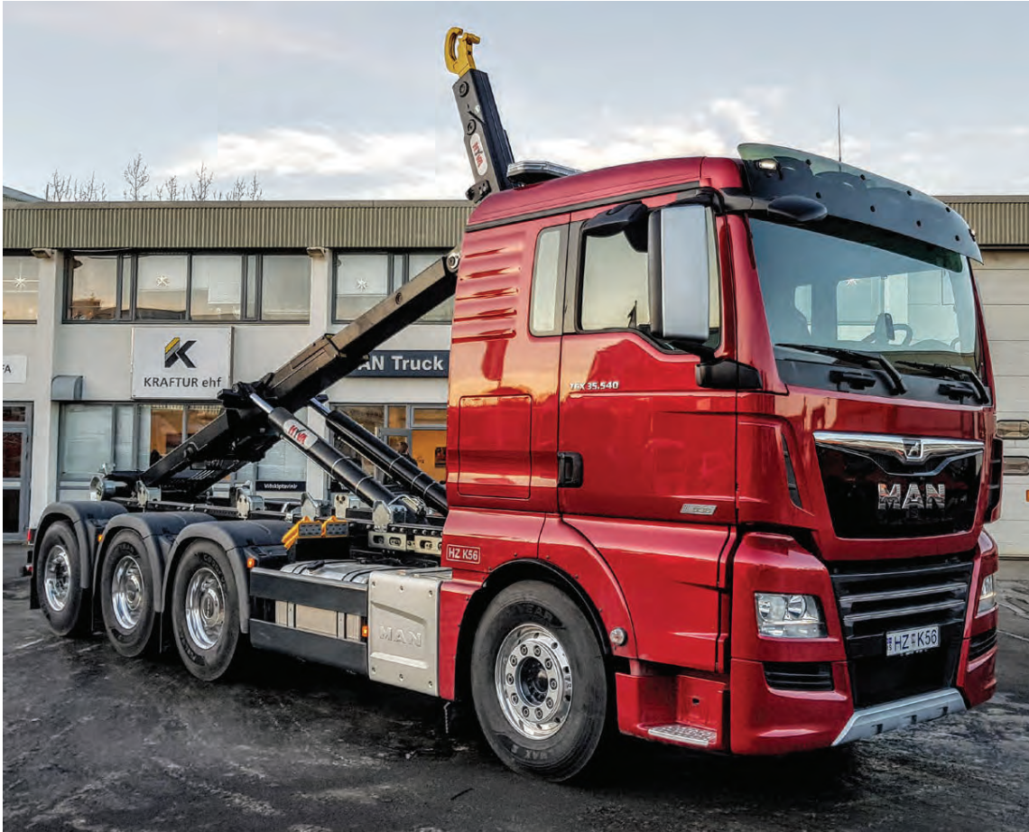
Bíll Jarðlausna, MAN TGX 35.540 8x4-4, er útbúinn rafstýrðum girkassa og vökvadrifinni undirakstursvörn frá Hyva.
