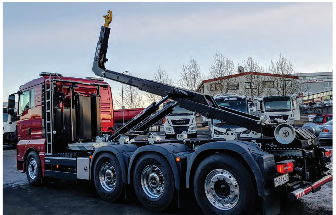
Bíll Jarðlausna er með loftpúðafjöldrun með vigtum að aftan og búinn 26 tonna krókheisi með beygjanlegum krók.
