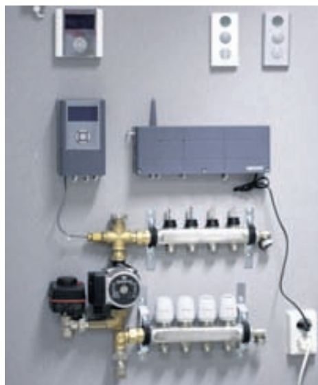
Dæmigerður stjórnbúnaður fyrir gólfhita. Þráðlausir hitanemar, móðurstöð, upplýsingaskjár og stjórnstöð sem stýrir framrás gólfhitans eftir útihita ásamt dreifiskistu og uppblöndun.
