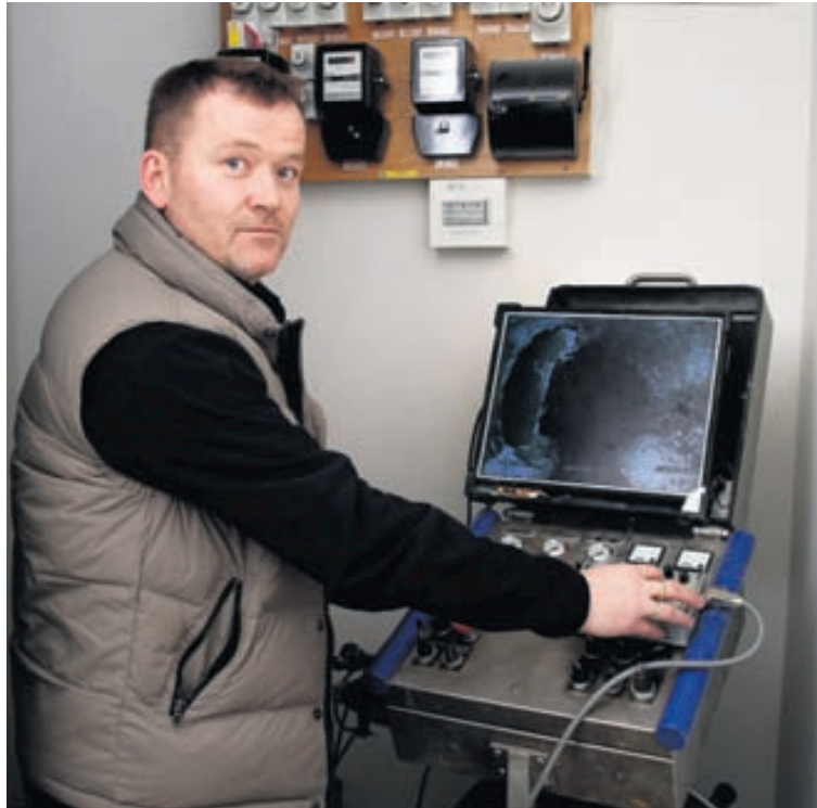
Til að athuga hvort allt sé með felldu í lögnum beitir Gísli sérstakri myndavél.
