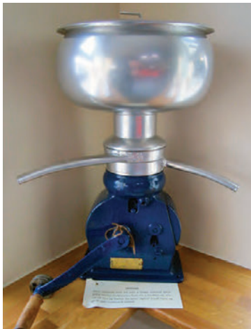
Á safninu eru einnig smærri tæki frá fyrri tíð eins og þessa skilvinda.
