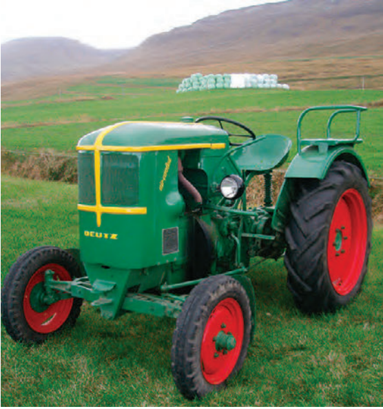
Deutz, 514 mótör, 15 hestafli, 1 strokks, árgærd 1955
