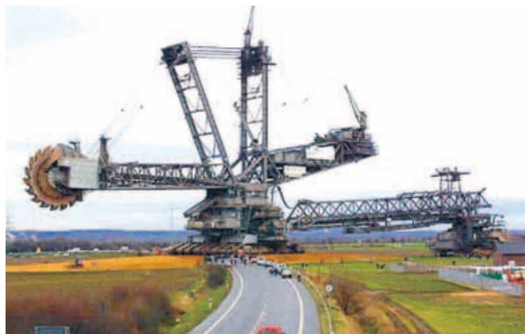
Þessi risavaxna grafa, byggð af Krupp, getur færst sig úr stað. Síðast lagði vélina í langferð árið 2001 og ferðaðist þá 22 kílómetra yfir vegi, lestarteina, akra og bæi. Fjarlægja þurfti rafmagnslínur og sandhrúgum voru helt yfir lestarteina og vegi til að koma í veg fyrir skemmdir.
