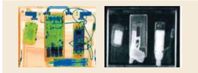
MISMUNANDI RÖNTGENVÉLAR, SAMA TASKA Í töskunni virðast vera nokkur raftæki, sími og straumbreytir. Myndin til hægri sýnir hvað hægt er að sjá með nýju vélunum. Í sömu tösku koma þá fram tvær gerðir sprengiefnis og skammtbyssa. MYND/JOHN HOOPER
