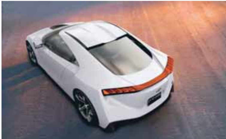
FT-HS er í raun svokallaður targa-bíll því hægt er að renna koltrefjapakinu aftur og fá vindinn í hárið.
