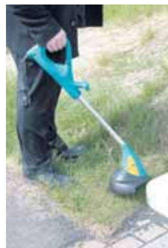
Rafmagnsknúin sláttuor. Lítt og meðfærilegt sláttuor. Hentar vel á minni flatir og á staði þar sem sláttuvél nær ekki til.
