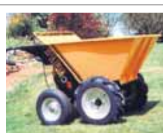
Bensindrífna hjólbörur. Vélknúna hjólbörur sem ganga fyrir bensíni. Henta vel í garðinn, á byggingarstaði eða þar sem flytja þarf hluti til og frá.
