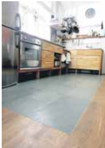
Eldhúsinnréttinguna smíðaði Thorsten úr eik. Með tækjum kostaði hún um 200.000, sem er tuttugu prósent af verði innréttinga sem þau höfðu skoðað áður. Fætur innréttingarinnar eru úr samlímdu parkettborðum sem voru slípuð og skorin í rétta stærð. Við innréttinguna er náttúrusteinn á gólfinu en gegnheit eikarparkett þar fyrir utan.
