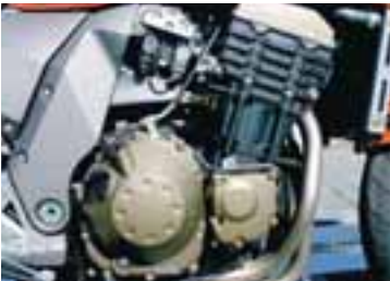
Vatnskælda 750 cc-innsþýtingarvélin er kjarninn í akstursánægjunni.
