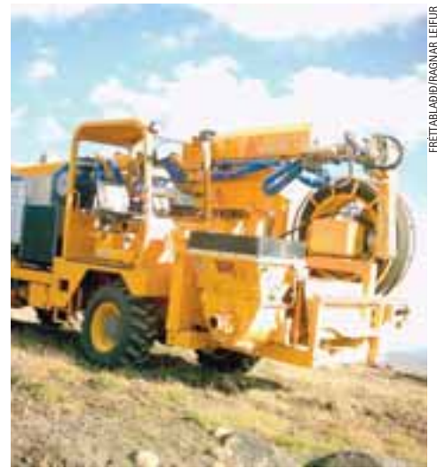
Steypusprautuvél er notuð til að styrkja stálið eftir sprengingarnar.
