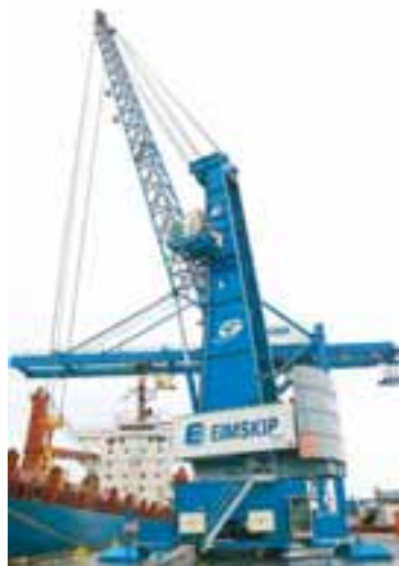
JARLINN: Stærsti bómukrani landsins og vegur um 400 tonn.
