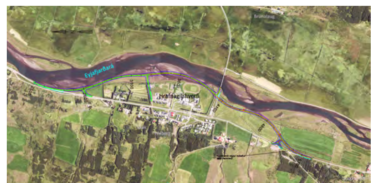
Verkefnið snýst um að flytja Eyjafjarðarbraut vestari austur fyrir Hrafnagilshverfið þannig að vegurinn liggi meðfram árbakka Eyjafjarðar. Vegalengdin er um 3,6 kílómetrar.
