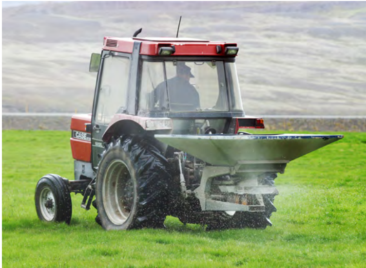
Við stillingu á áburðardreifara þarf að hafa í huga þyngd, kornastærð, kornagerð og brotþol áburðarins. Þyngdin og kornagerðin hefur áhrif á flæðið í gegnum áburðardreifarann og hvernig áburðurinn ferðast frá honum.
