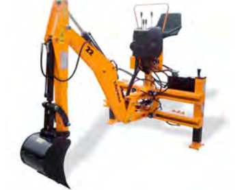
Backhoe fyrir dráttarvélar og hjólaskóflur. Margar stærðir. Gröfudypt- 1,3 - 4,2 metrar. Margar stærðir af skóflum og öðrum aukabúnaði. Hákonarson ehf. S. 892-4163, hak@hak.is , www.hak.is
