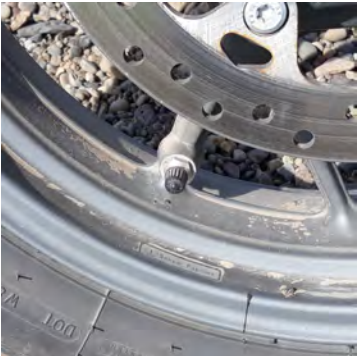
Vissulega er auðvelt að pumpa í dekkið með ventilinn þarna. En ef felgan bognar er hægt að nota slöngu – en þá vantar gat fyrir ventilinn.
