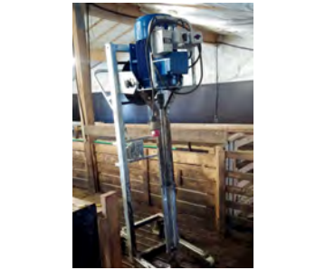
Innihærur fyrir haugkjallara. Rafdrifnar (3 fasa) eða glussadrifnar. Vinnudýpt: 130 cm eða meira. Einnig hægt að fá hræurnar glussadrifnar með festingum fyrir gálga á liðléttingum. Hákonarson ehf. Uppl. í s. 892-4163, hak@hak.is / www.hak.is
