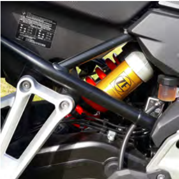
Fjöðrunin stillist eftir þyngd sem hjólið á að bera. Hægt er að hækka hjólið með einum takka úr 77 cm í 84 cm.
