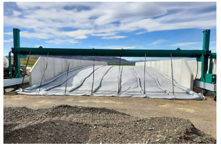
Nýr yfirbreiðslubúnaður á stæðu í Gunnbjarnarholti og fjölnota dúkur. Eftir dúkunum endilöngum liggja saltþækilslagir sem halda honum niðri.
