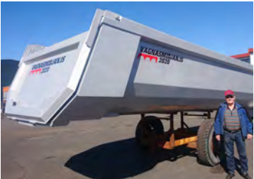
Vagnasmiðjan auglýsir: Getum nú afgreitt þessa flottu Hardox skúffu á trailervagn, með botnplötu úr 8 mm. Hardox 450 stáli sem nær upp á miðjar hliðar (50 cm upp í gegnum allar beygjurnar). Fram og afturgafi ásamt hliðum úr 5 mm Hardox 450 stáli. Fæst á gamla verðinu. Til afgreiðslu strax. Einnig sterkar og ódýrar krókgrindur. Án gámalása, kr. 280.000 +vsk. Með gámalásam, 380.000 kr. +vsk. Vagnasmiðjan Eldshöfða 21 R.vík s. 894-6000.
