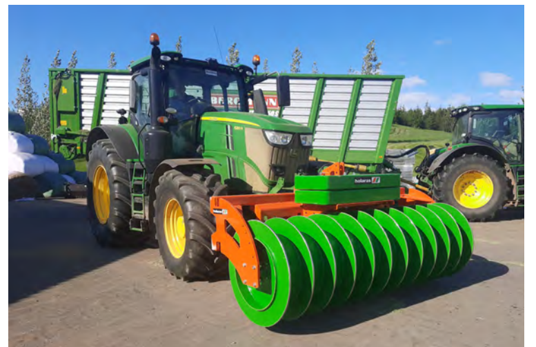
Sérstakur stæðuvaltar í Gunnbjarnarholti. Þunginn kemur niður á granna snertifleti sem þrýsta heyinu niður í stæðuna.
