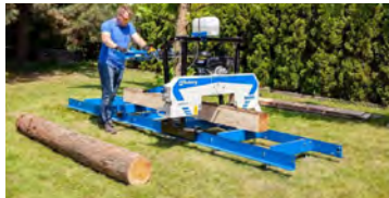
Stórviðarsög á braut. Aflgjafar: Kohler bensinmótorar eða rafmótorar. Lengd á braut: 3,8 m, hægt að lengja um 1,52 m eða meira. Mesta þykkt á trjábol: 66 cm. Framleiðandi, Timberly í Póllandi. CE merktur og vottaður búnaður. Hentar í alla stórviðarsögum. Hákonarson ehf. S. 892-4163, netfang: hak@hak.is
