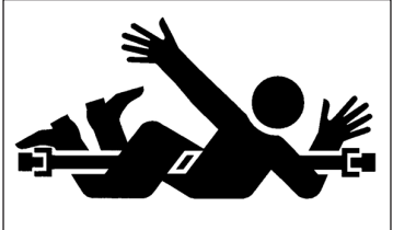
Aflúrtök eða drifsköft á vinnuvélum eru alltaf hættuleg og drifskafthlífar eru því lífsnauðsynlegar.
