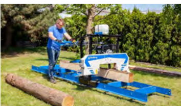
Stórviðarsög á braut. Aflgjafar: Kohler bensínmotorar eða rafmotorar. Lengd á braut: 3,8 m, hægt að lengja um 1,52 m eða meira. Mesta þykkt á trjabol: 66 cm. Framleiðandi, Timbery í Póllandi. CE merktur og vottaður búnaður. Hentar í alla stórviðarsögum. Hákonarson ehf. S. 892- 4163, netfang: hak@hak.is
