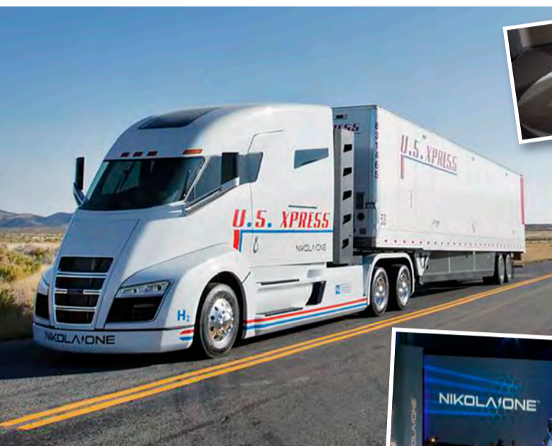
Nikola One er frumgerð af 18 hjóla vetnistrukk Nikola Motors sem er með 1.000 hestafla mótör. Hann er með léttbyggðan vetnistank sem gerður er úr koltrefjum og á hann að komast yfir 1.200 kílómetra á einni tankfyllingu.
