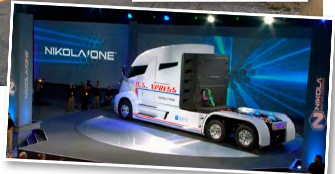
Nikola One er frumgerð af 18 hjóla vetnistrukk Nikola Motors sem er með 1.000 hestafla mótör. Hann er með léttbyggðan vetnistank sem gerður er úr koltrefjum og á hann að komast yfir 1.200 kílómetra á einni tankfyllingu.
