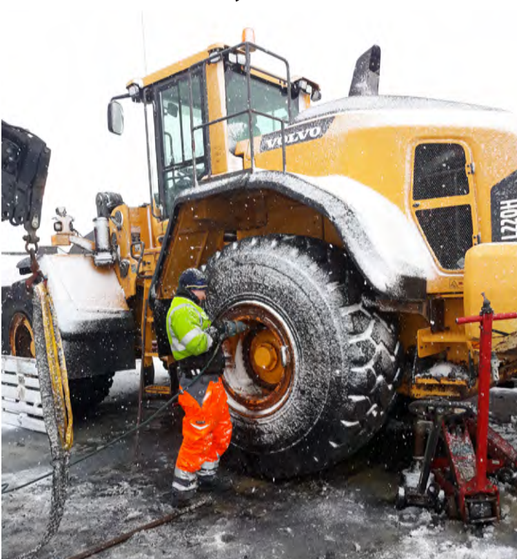
Felgubolta undir stórum vinnuvélum þarf stundum að margherða.
