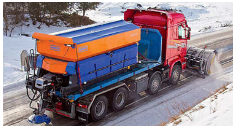
Vörubíll með sanddreifara og snjótennu.
