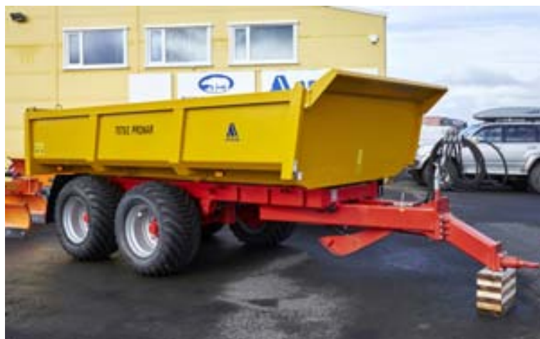
Það nýjasta frá Pronar hér á landi eru krókheysisvagnar og malarvagnar með sturtu og hardoxi í skúffunni.
