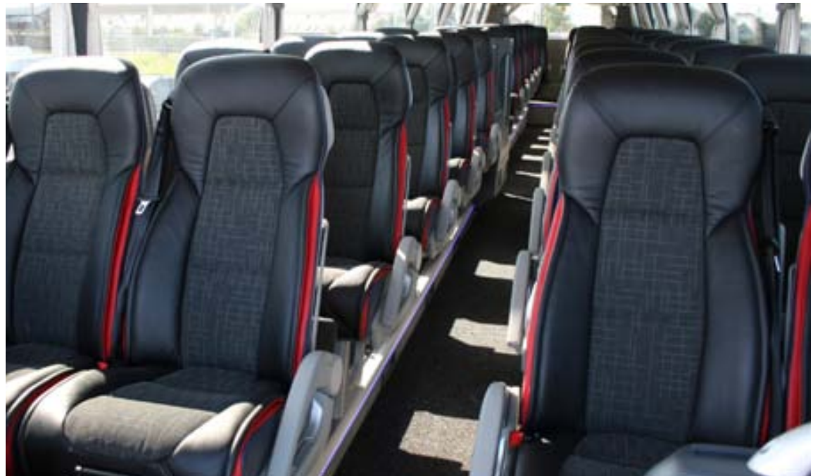
Hægt er að breikka bil milli sæta í Volvo 9900 og meira pláss er á milli sætaraða, rafmagnstenglar eru við hverja sætaröð til að hlaða síma eða tölvur.
