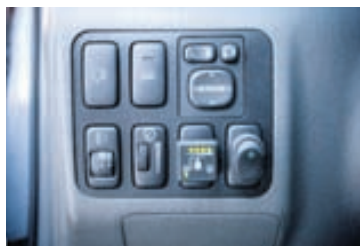
Snyrtilegur hnappur er inni í bílnum með metanmæli og rofa þar sem hægt er að slökkva og kveikja á metanbúnaðinum.
