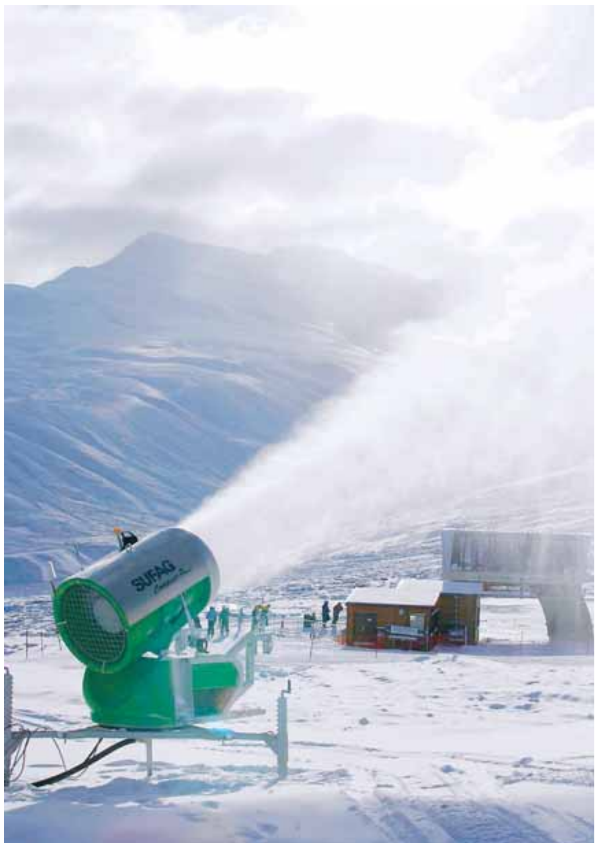
Snjóbyssurnar í Hlíðarfjalli eru feikilega afkastamiklar í miklu frosti og getur hver vél framleitt snjó úr allt að 600 lítrum vatns á mínútu.
