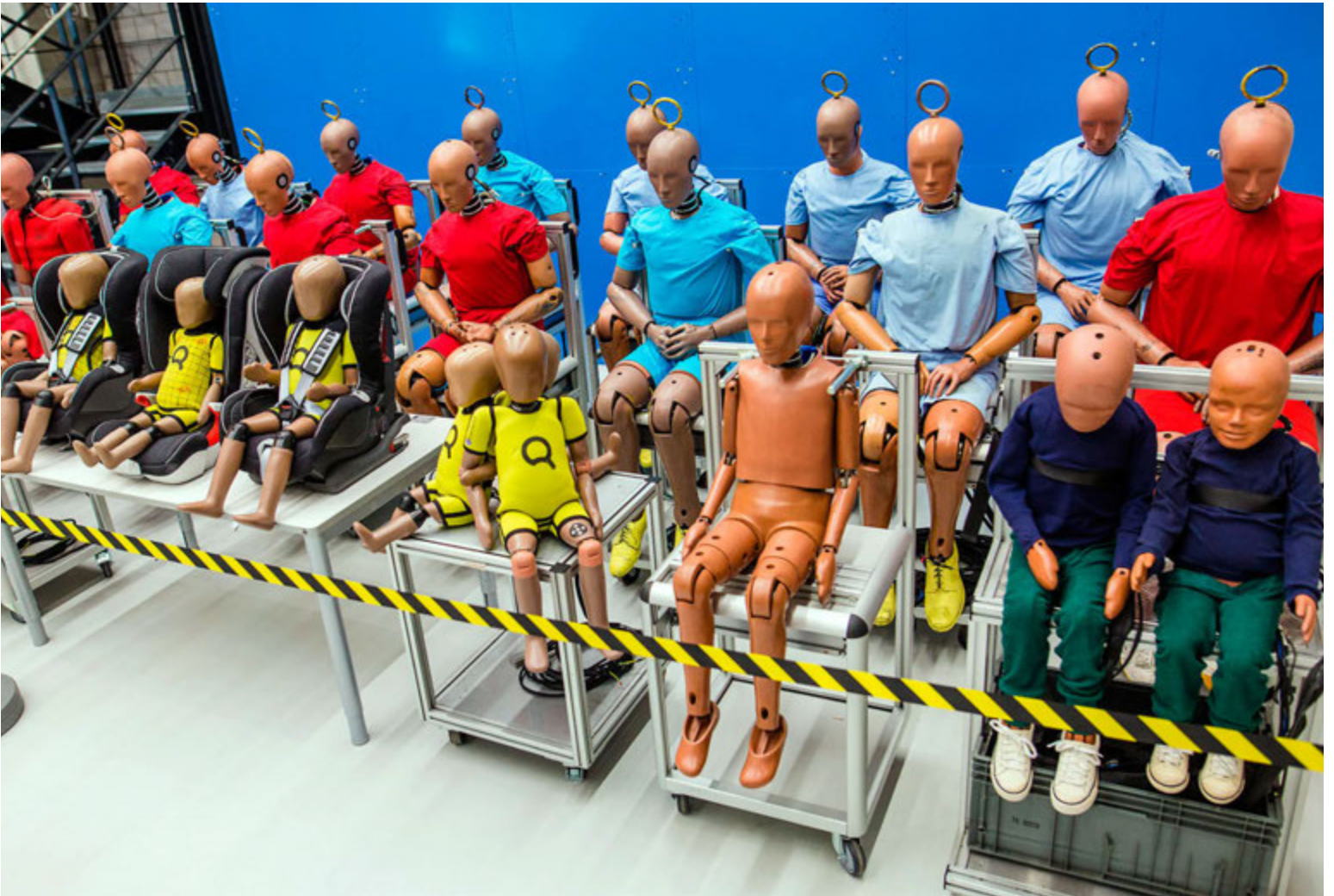
Fjölmargar brúður bíða eftir því að vera notaðar í æfingakeyrlu hjá öryggstækni Merced-Benz í Sindelfingen í Þýskalandi. Brúðurnar eru notaðar í stað fólks til að prófa öryggi bíla úr smíðju þýska framleiðandans. Þær eru meðal annars notaðar til að prófa bílbelti. FRÉTTABLAÐIÐ/AFP
