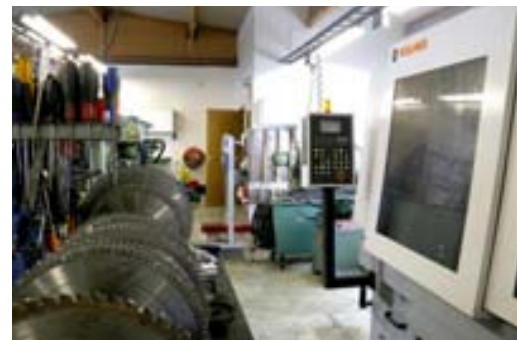
Í sjálfvirkri segulplanvélinni er hægt að skerpa rúmlega þriggja metra langar tennur.
