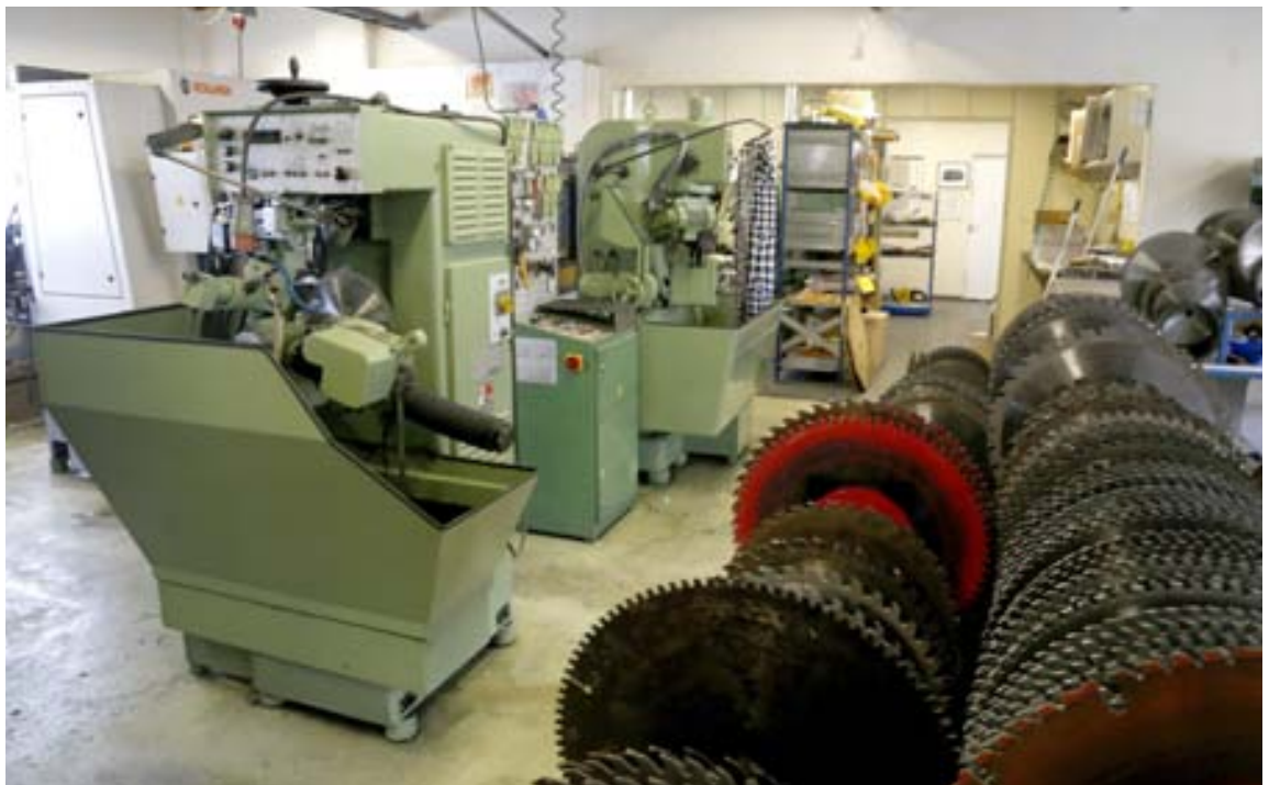
Í sjálfvirkri segulplanvélinni er hægt að skerpa rúmlega þriggja metra langar tennur.
