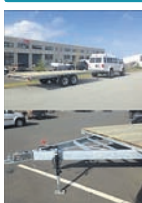
Flatvagn, nýsmíðaður. Fletið er 6 metrar x 2,5 metrar plús beisli sem er 1.8 meter. 2 öxlar, hvor 2.700kg burðargeta. frá Stál og Stönsum. Heildregnar 120mm skúffur í grind. 60mm x 60mm prófilar í ramma. Vökvabremsur. Klædd með gagnvörðu timbr. Eigingþyngd er um 1.000 kg. Er á felgum og burðardekkjum undan Dodge. Led ljós allan hringinn. Gert ráð fyrir að hægt sé að hafa sliskju undir. Prófilhóllkar á báðum hliðum með jöfnu millibili fyrir festingar eða skjólborð. Ásett er 1.5 milljón. Hægt er að fá vsk nótu. Er í hafnarfirði, óskráð. Bjarni 820 0820.
