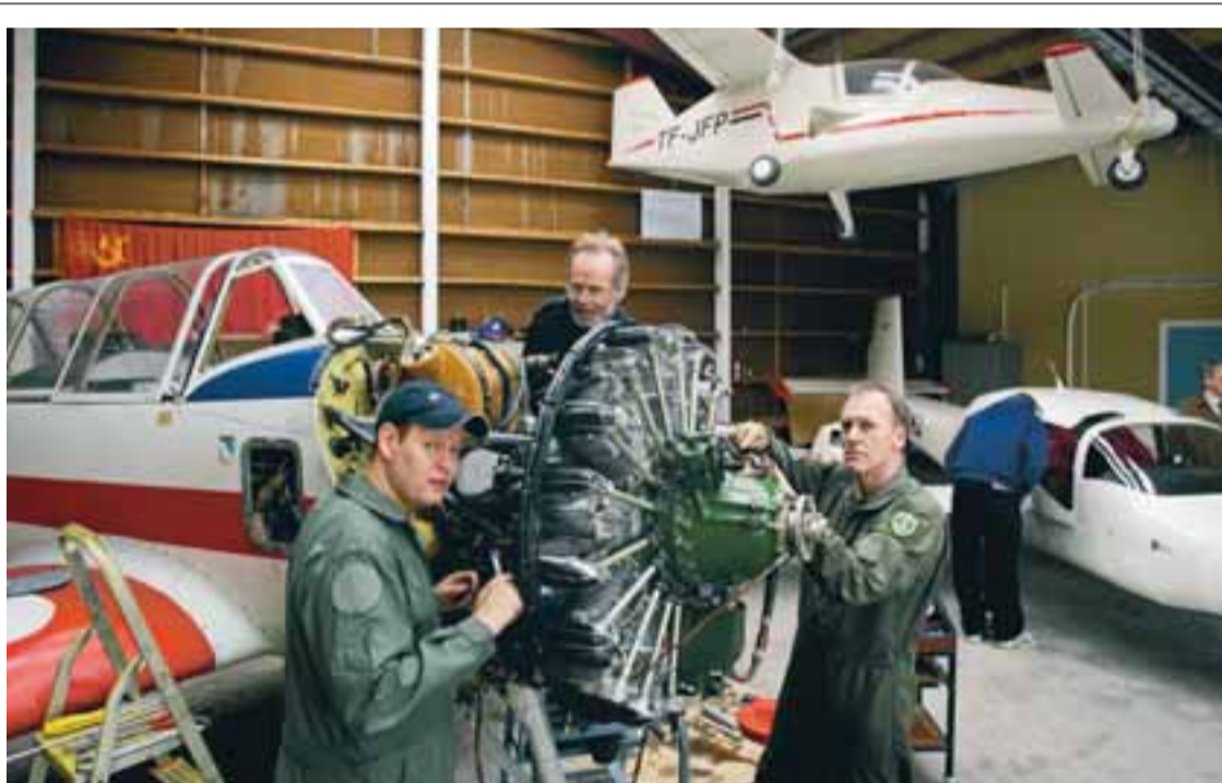
SKIPT UM MÓTOR Félagarnir Hjalti Grétarsson, Einar Rafnsson og Páll Indriði Pálsson skipta um mótör í rússneskri flugvél. Vélin ætti að vera komin í lag fyrir flugsýninguna á laugardaginn.
