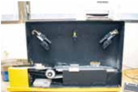
Mælitækið er notað til að prófa framleiðslu frá jarðefna- og steinefnaíðnaðinum, til dæmis mól, sand og grjót sem eru hráefni í steypu og fleira.
