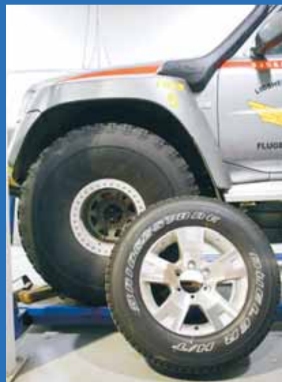
Þessi björgunarsveitarbílur er í breytingu hjá Arctic Trucks. Dekkið sem var undir bílunum liggur nú upp að hinu nýja sem er tvöfalt breiðara og mun stærra að öllu leyti.
