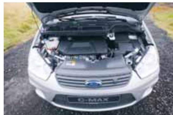
Flexifuel-vélin í Ford C-Max gengur bæði fyrir bensíni og líf-etanóli. Koltvísyringsútblástur dregst saman um allt að 80 prósent þegar hún gengur á etanól.
