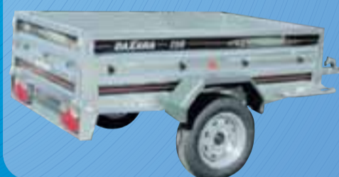
Daxara 198 Sturtubúnaður, 13" dekk, opnanl. gafl framan og aftan Innanmál 184x114x40 cm Burðargeta 590 kg
