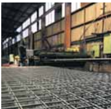
Motturnar tilbúnar. Þær algengustu eru með 15 sm möskva í þvermál.
