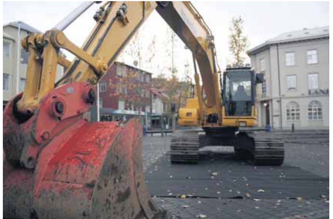
Das-8 vélar eru með sérstaklega styrktu stjórnhúsi sem tryggir aukið öryggi þeirra sem á þeim vinna.
