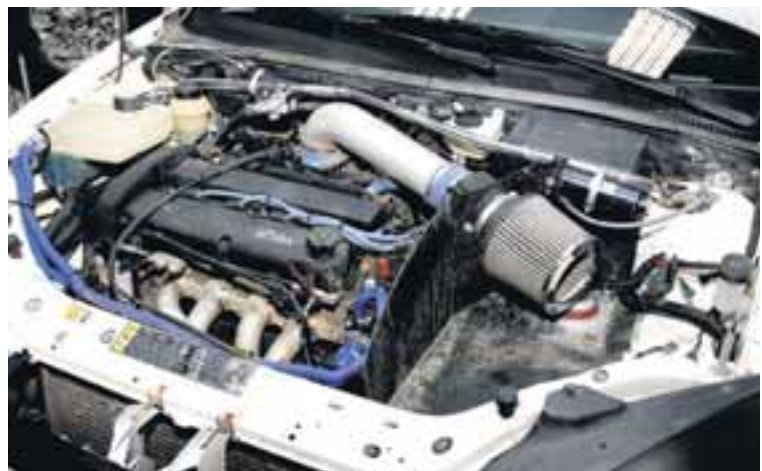
Vélin er 2,0 lítra vél með flækjum og opnu pústkerfi. Vélin skilar 180 hestöflum en leyfilegt hámark í rallí héraendis er 300 hestöfl.
