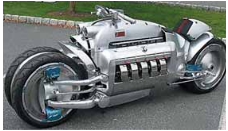
Dodge Tomahawk. Stútarnir fyrir ofan framhjólina eru ekki ljós, heldur loftinntak fyrir 500 hestafla V-10 mótörinn. Ekki slæmt fyrir mótörhjól.
