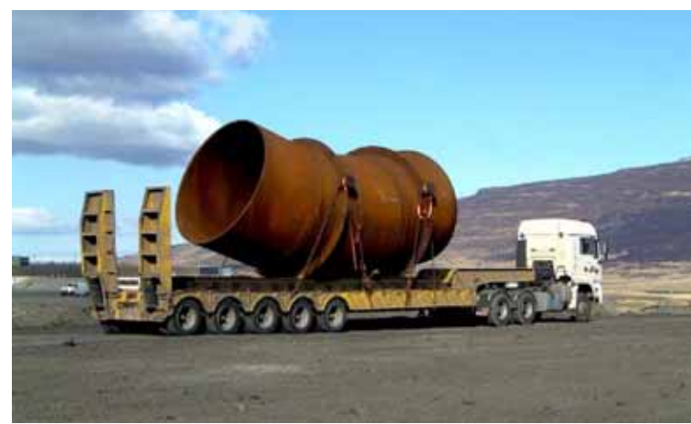
STÁLROUR Í FALLGANGAFÓÐRINGU Stálror á borð við þetta hér á myndinni eru notuð til að fódra aðrennslisgöng í stöðvarhúsi Kárahnjúkavirkjunar í Fljótsdal.
