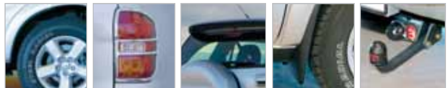
Heilsársdekk Krómgrind á afturljós Vindskeið Aurlífar Dráttarbeisli
